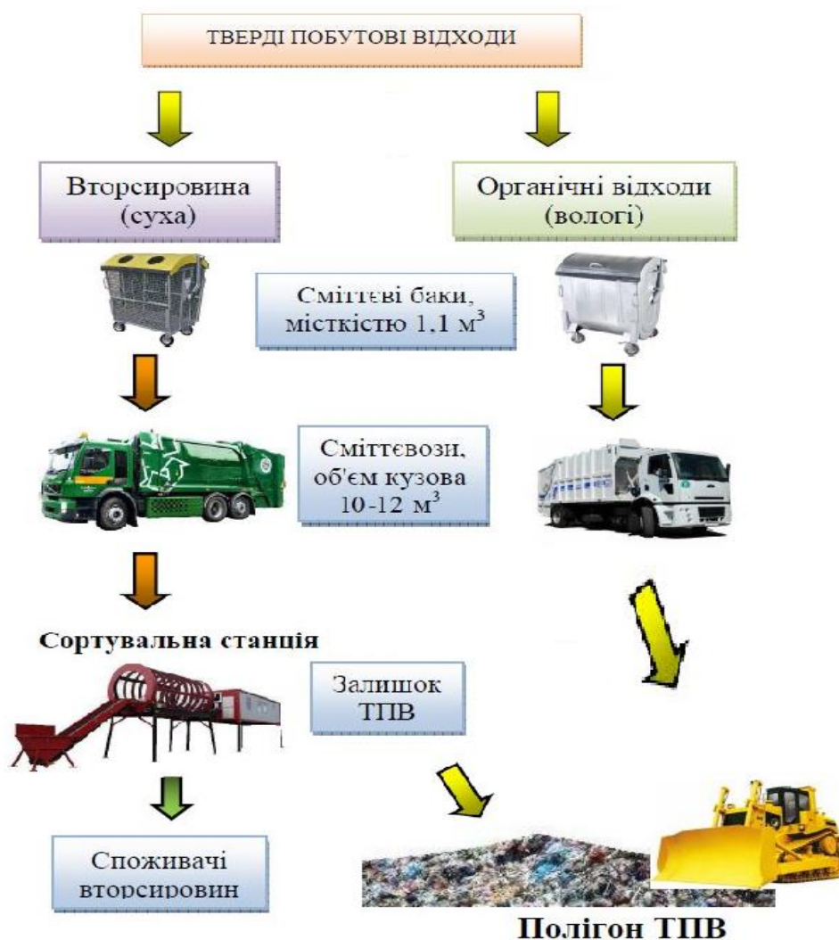
Рис. 2.6 Схема сортування ТПВ на 2 потоки
