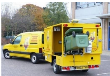
Фото. Обладнання для миття контейнерів на причепах
