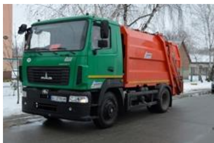
Фото. Сміттєвоз МАЗ з кузовом 18 м 3
