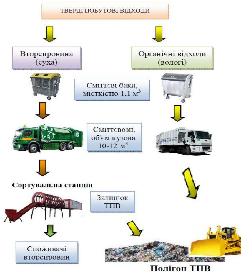
Рис. 2.1 Схема сортування ТПВ на 2 потоки
